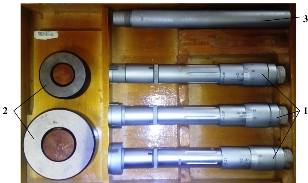
Fig. 6. Trusa de instrumente cu șurub micrometric tip „holtest” a.- set de trei instrumente; b.- set de două calibre inel; c.- prelungitor
