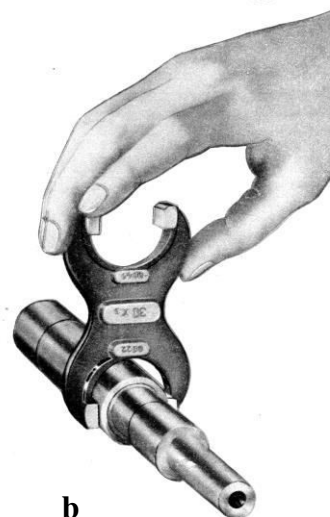
Fig. 6. Verificarea arborilor cu calibrul furcă T și NT
