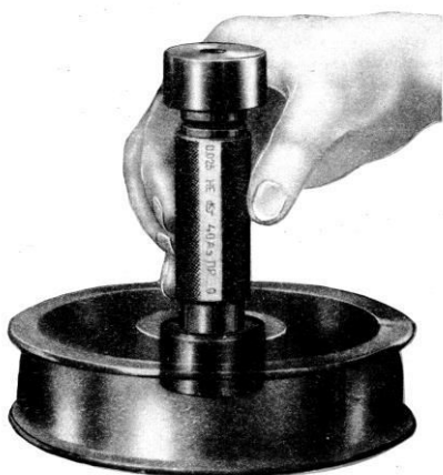
Fig. 5. Verificarea alezajelor cu calibrul tampon cilindric
