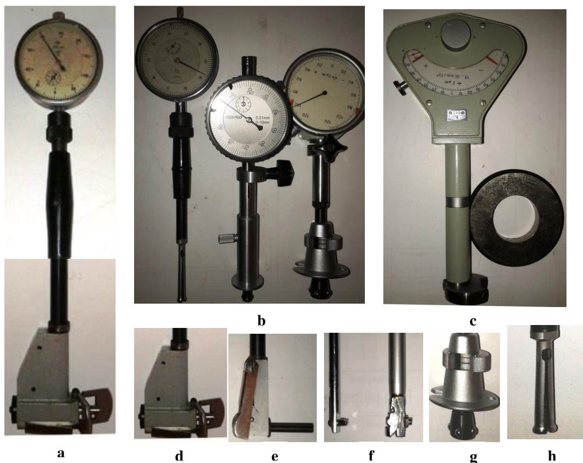
Fig. 2. Comparatoare de interior
