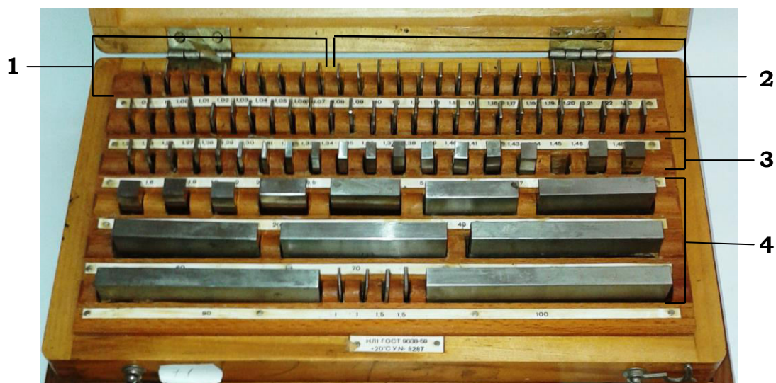
Fig. 2. Trusa de cale plan- paralele
